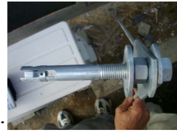
・ボルト、ブレース組付け状態
